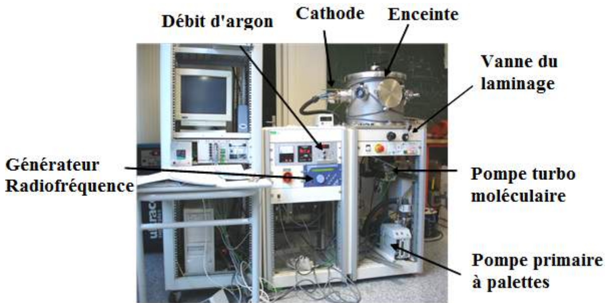
FIGURE IV.2 – Bâti TSD 350 de pulvérisation RF
