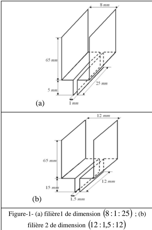
Ces filières sont équipées de vitres latérales permettant la visualisation de l'écoulement dans la section de contraction, et de crayons chauffants pour imposer la température fixée. Le débit est assuré par une petite extrudeuse de laboratoire avec une précision d'environ 1% .
