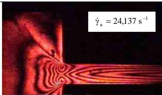
Figure-6- Cliché de biréfringence induite par l'écoulement du PEbd-IUPAC à 150°C
